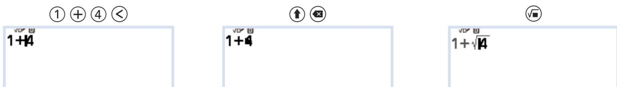
En el modo de "E Línea" (entrada en línea) si se utiliza  $\text{INS}$ , el cursor aparece como "            " y el texto que se introduzca sustituirá al texto que hay en la posición del cursor.
