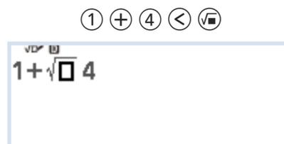
Para conseguir  $1+\text{raiz}(4)$  hay que situar el cursor entre el + y el 4 y pulsar  $\text{INS}$ , en ese momento el cursor se convertirá en un triángulo que apunta hacia la derecha, y la calculadora utilizará el 4 como argumento para la función seleccionada:
